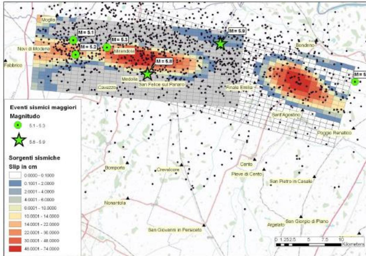
Figura 5 - Modello preliminare delle sorgenti dei principali eventi della sequenza emiliana. Per la sorgente del mainshock manca gran parte della distribuzione di slip (aree trasparenti) in quanto in quelle aree manca il dato SAR COSMO-SkyMed.
